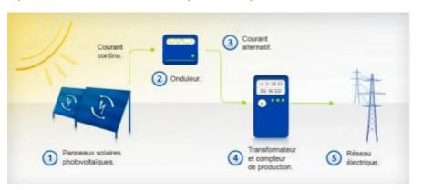
Figure 10 : Schéma descriptif du fonctionnement des modules solaires
